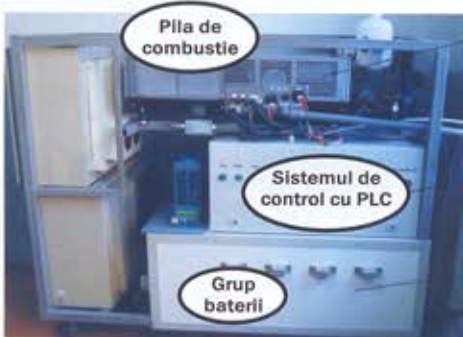
Fig. 5. Sistemul de control și management al energiei pentru o instalație hibrid electrică cu pilă de combustie. Buteliile de hidrogen sunt dispuse într-un spațiu alăturat, cu semnalizări și protecții la pericol.
